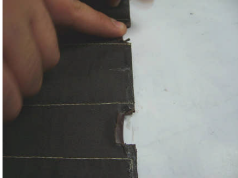
Fotoğraf 4.4: Çentikli yerlerin kıvrılması
