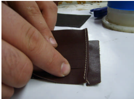
Fotoğraf 3.13: Kredi kart üst derleri kartlıkla birleştirilmesi
