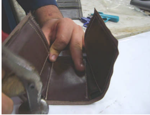
Fotoğraf 4.6: Orta kısmın yapıştırılması
