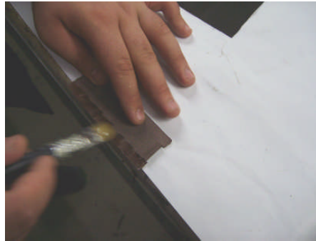
Fotoğraf 3.7: Çeltikli parçalara yapıştırıcı sürerken
