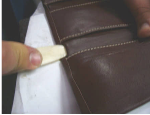
Fotoğraf 4.9: Kenar kıvrırma da çentikler
