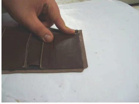
Fotoğraf 4.5: Ana gövdeye orta parça montajı
