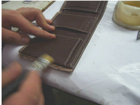
Fotoğraf 4.7: Kenarlara yapıştırıcı sürme
