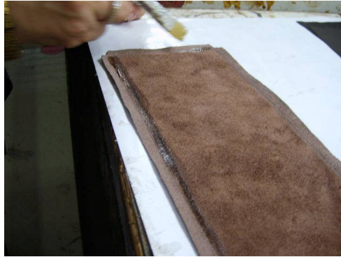
Fotoğraf 4.1: Ana gövdeye yapıştırıcı sürme
