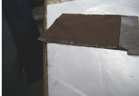
Fotoğraf 3.12: Sağ ve sol kredi kart üst derilerin astarlanması
