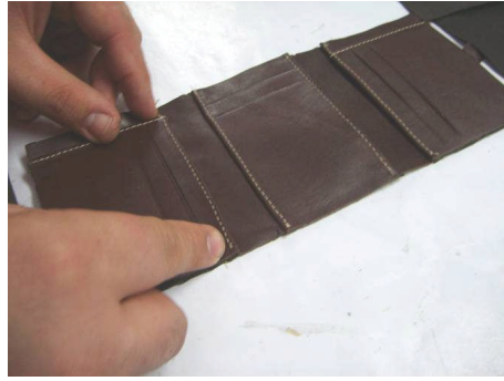
Fotoğraf 3.15: Kartlıkların montajı
